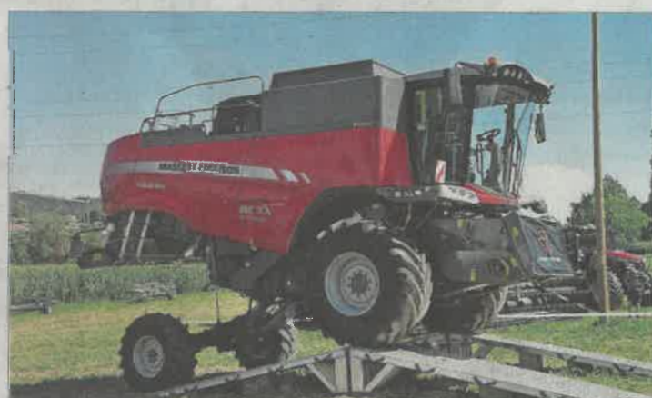
Im Bereich der Mähreschertechne wurden die Möglichkeiten zum Hangaussgleich gezeigt. (Bild: Isabelle Schwander)
